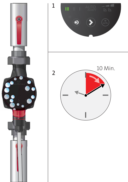
Abb. 24 Entlüften der Pumpe
